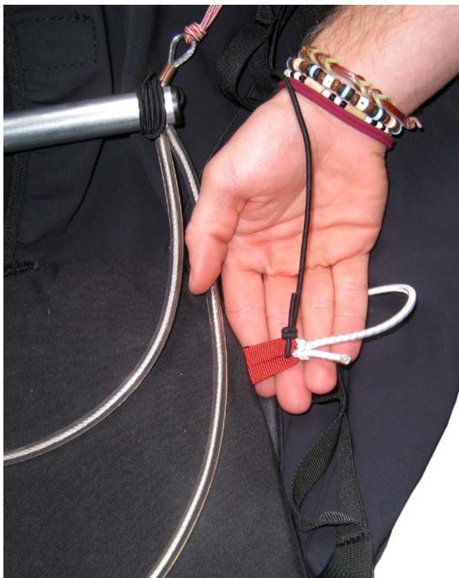
A questo punto, passare l'ultimo step all'interno del secondo in modo da ottenere una certa rigidità dei due. Attorcigliare gli elastici, precedentemente annodati al fondo piedi della LEG COVER, ai due step dello speed come da foto. Infine, annodare gli elastici negli occhielli dello speed.
