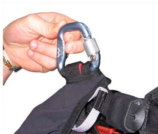
Infine, per far aderire al meglio la LEG COVER all'imbragatura avvolgere le fasce laterali in velcro, poste all'interno della licra, alle cinghie portanti dell'imbrago (cinghia principale di collegamento fra moschettone e seduta) e agganciare la parte inferiore del copri gambe tramite i velcri della stessa ai velcri del porta speed.
