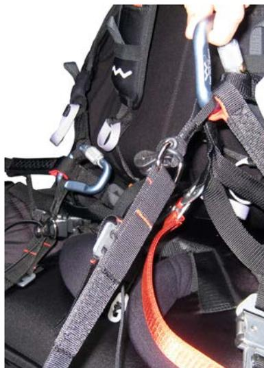
Infilare la licra sul moschettone al di sopra di tutto il cinghiaggio. In questa fase è possibile che sia necessario smontare il moschettone dall'imbragatura. In questo caso fare particolare attenzione a reinserire tutte le cinghie nel moschettone nella corretta sequenza.
